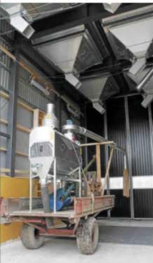
Asymmetriskt placerad tippgrop och sex utlastningsfickor.
